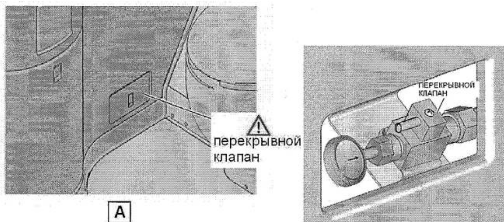
Рисунок 4.9.5г Расположение перекрывных клапанов в туалетных модулях
