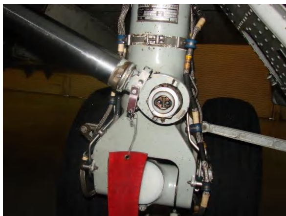
Рис. 12.2. Установка страховочных пинов (штырей), основные стойки шасси.
