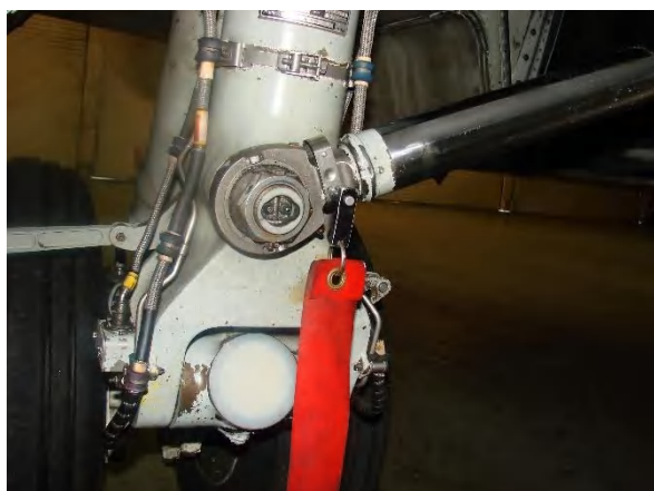
Рис. 16.2. Установка страховочных пинов (штырей), основные стойки шасси.
